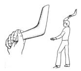
O segredo do movimento do boomerang está nas forças aerodinâmicas que se exercem sobre suas lâminas devido ao seu perfil. Estas forças atuam perpendicularmente
